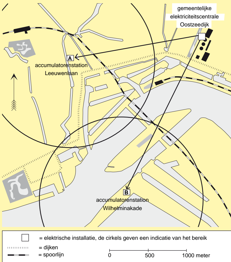
9. De gemeentelijke elektriciteitscentrale werd gevestigd naast de Gemeente Gasfabriek aan de Oostzeedijk. Vandaaruit liepen kabels naar twee 'accustations'. Accustation A voorzag de binnenstad van elektriciteit, voornamelijk voor verlichtingsdoeleinden. Accustation B leverde de krachtstroom voor de haveninstallaties aan de overzijde van de Maas. (Tekening auteur)
