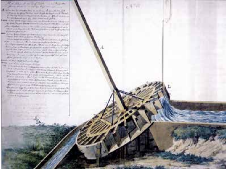
Hellend scheprad. In Schieland is heel wat geëxperimenteerd met het hellende scheprad, een uitvinding van Antoine George Eckhardt (1771).
