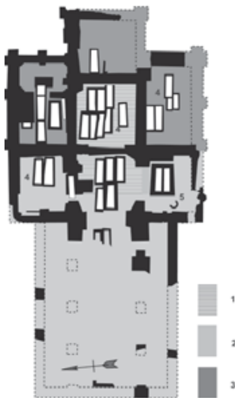
Afb. 5. Plattegrond van de kerk van Hannekenswerf met zijn bouwfases. Het teruggevonden muurwerk is in zwart aangegeven, met stippellijnen is de reconstructie van de plattegrond aangevuld. Schaal 1:200. Legenda: 1. Kapel, midden twaalfde eeuw; 2. Romaanse kruiskerk, laatste kwart twaalfde eeuw; 3. Uitbreidingen in baksteen, dertiende eeuw; 4. Grafkelders; 5. Klokvorm (tekening: R. de Nennie naar Van Hinte 1963-1964).
